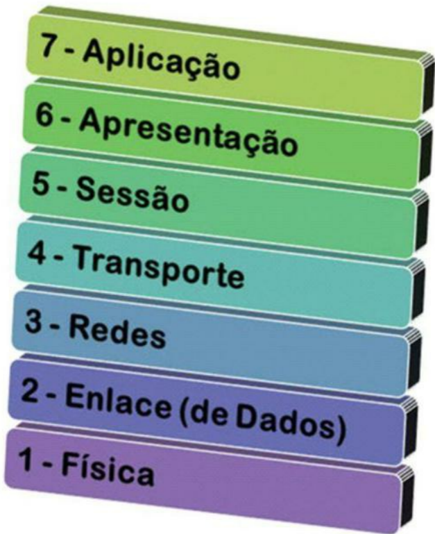
Figura 8.59 – Modelo de referência ISO/OSI.
