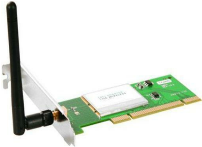
Figura 8.42 – Placa de Rede Wi-Fi (note a antena) “G” encaixável no barramento PCI.
