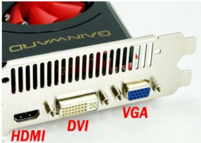
Figura 2.81 – Saídas comuns na placa de vídeo (HDMI, DVI e VGA).
