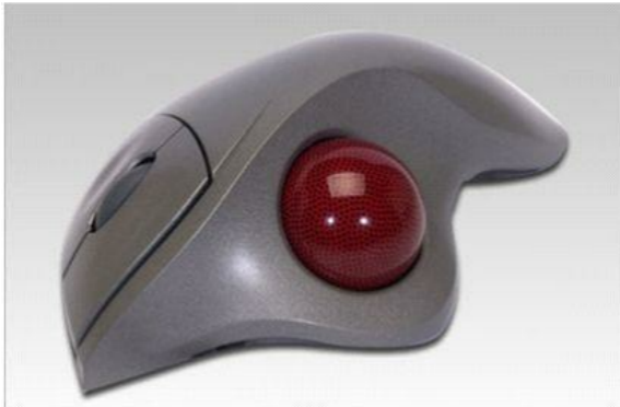
Figura 2.63 – Trackball (não se mexe em relação à mesa; a gente gira a bolinha).
