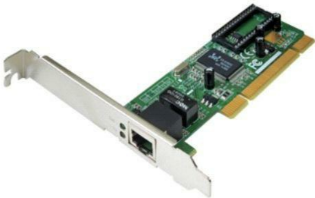
Figura 2.77 – Placa de rede Ethernet (interna ao gabinete).
