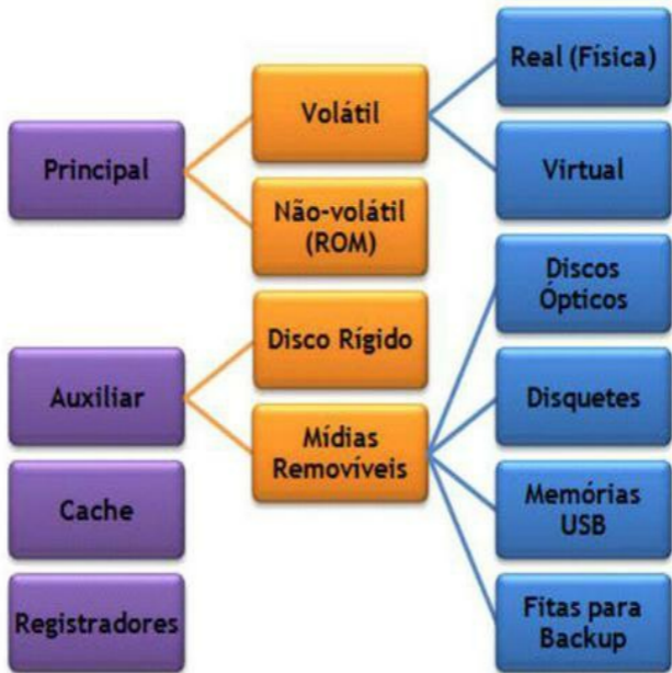
Figura 2.42 – Organização das memórias de um computador por sua função.
