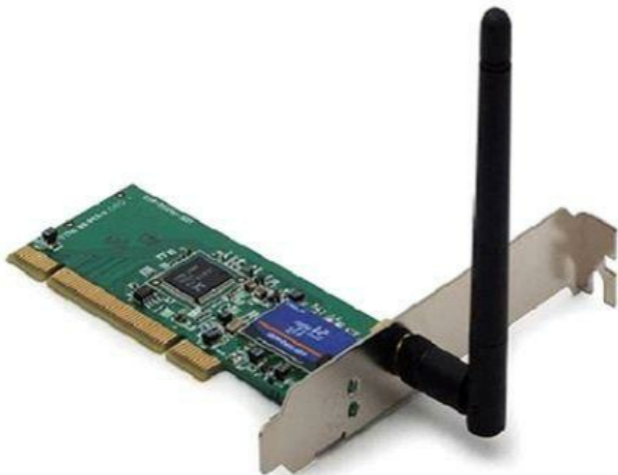
Figura 2.78 – Placa de rede Wi-Fi.
