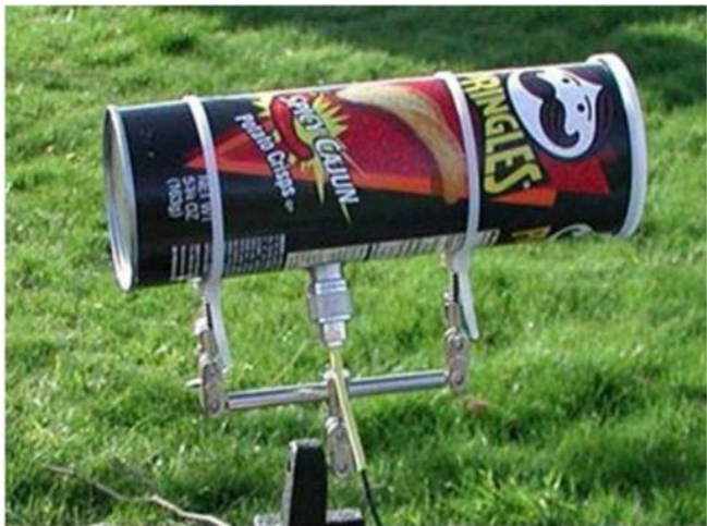
Figura 8.38 – Antena direcional feita com lata de batatas.
