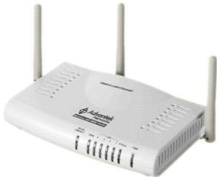
Figura 8.39 – Roteador + Ponto de acesso com tecnologia MIMO.
