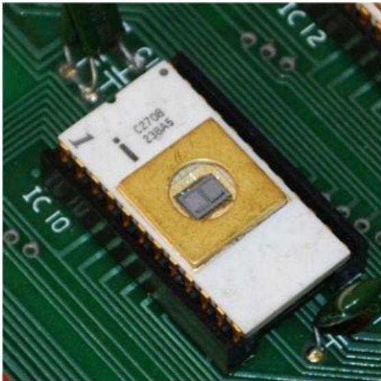
Figura 2.40 – Um chip de memória EPROM – note a “janela” de vidro em cima dele.
