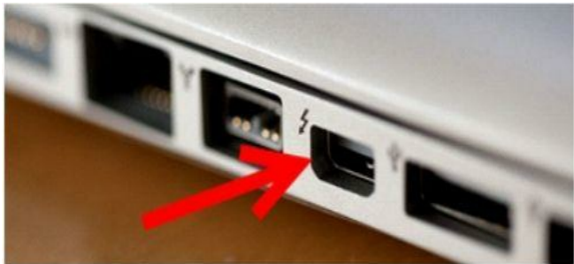
Figura 2.103 – Porta Thunderbolt (a mesma da saída Minidisplay Port).
