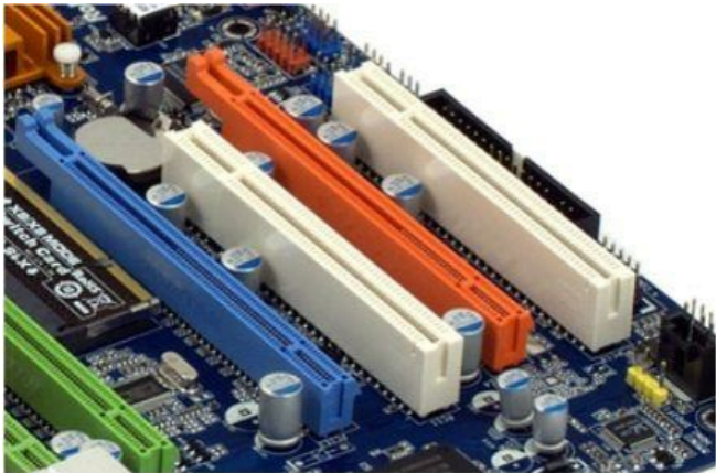
Figura 2.89 – Dois Slots PCI (os brancos).
