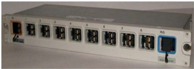
Figura 8.35 – Uma MAU (um concentrador Token Ring).
