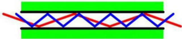
Figura 8.13 – Esquema de funcionamento da fibra multimodo.
